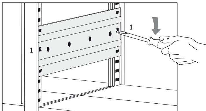
1 Eingebogene Stifte der Stabilisierungsplatte auf beiden Seiten lösen
