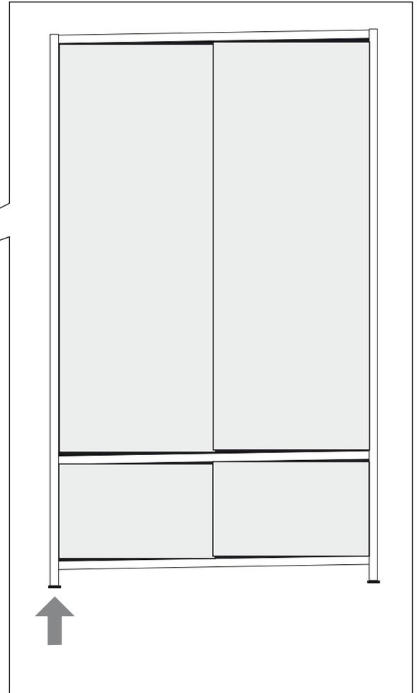
Bei diesem Beispiel sollte der linke Fuss mit dem Keil unterlegt werden.
