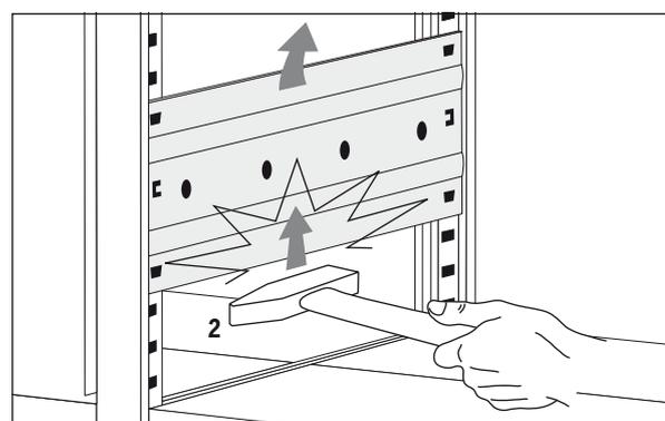
2 Stabilisierungsplatte durch leichtes Klopfen entfernen
