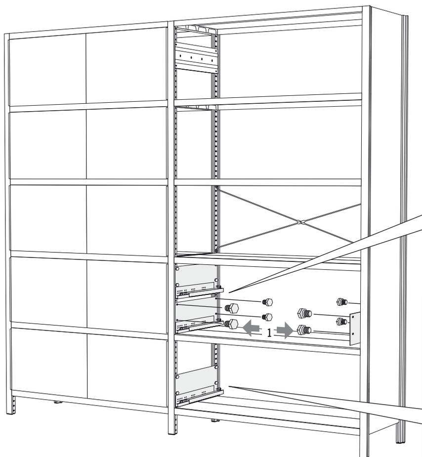
**Bemerkung:** Falls eine Kreuzverstrebung die Montage der Schublade behindert, diese an einer neuen Stelle anbringen.
