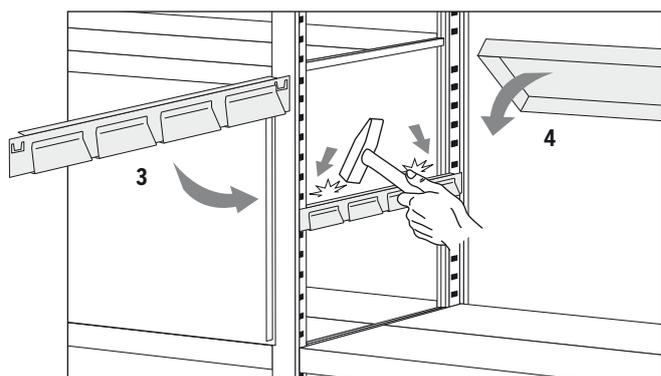
3 Tablarträger an gewünschter Position einfügen und auf beiden Seiten leicht anklopfen
