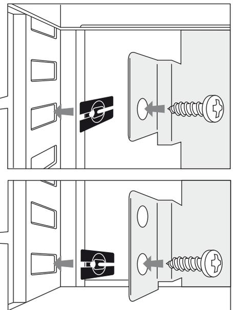
Enden die Rückwände nicht hinter einem Tablar, werden diese mit einer Verbindungsschiene verbunden (z.B. hinter Garderoben-Türen).
